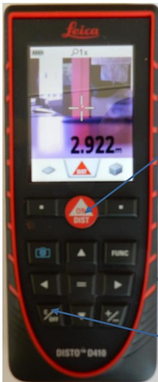
Pour prendre la mesure, appuyer sur ce bouton. Parfois, la mesure n'a pas pu être prise, appuyer une seconde fois.
