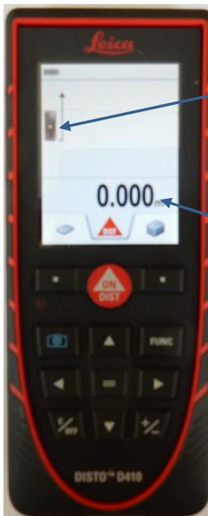
Ce symbole indique que la mesure est calculée à partir de la base du télémètre.
